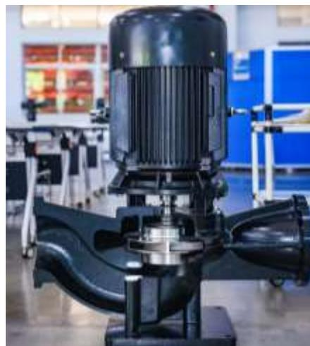
铸铁部件均采用特殊的阴极电泳处理，多达22道工序，完全覆盖且经久耐磨，附着力强，减小摩擦力，提高泵整体效率1-2%，可避免喷漆的不均匀性，同时电泳处理的泵消除了锈蚀。盐雾试验Ri0级 120小时，确保5年不掉漆。
