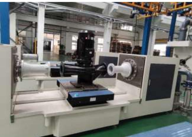
严格按照标准进行100%静压（密封）试验，确保整泵无泄漏、冒汗现象。
