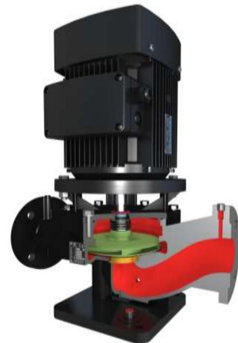
10年以上部分铸铁叶轮生锈严重、口环磨损间隙加大后效率**大幅下降7-8%**，每年增加**75%以上**的运行成本，采用不锈钢叶轮配合耐磨口环后全生命周期成本改善优势明显。
