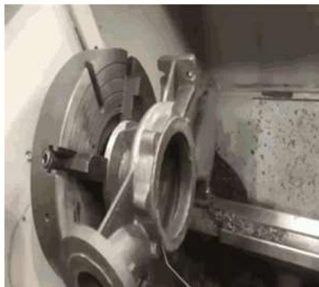
泵体原普车加工，多个工序，多次装夹找正，关键尺寸同轴度无法保证，导致装配后发生偏磨、卡死等现象。
